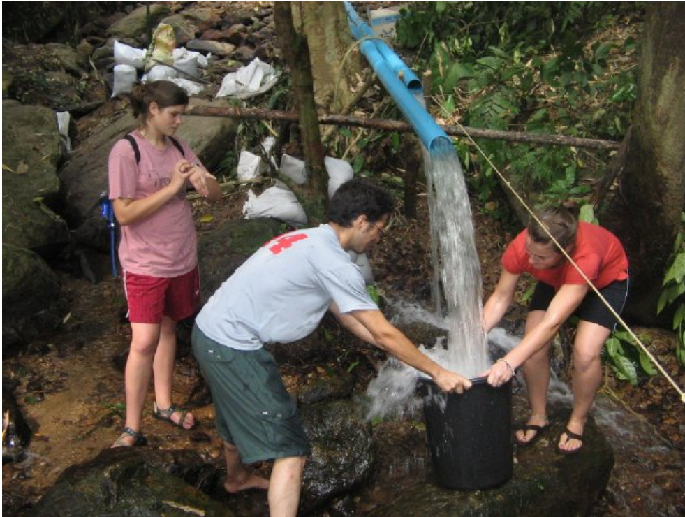
รูปที่ 11: แอนดรู และฟาร์เรนถือถังน้ำเพื่อวัดการไหลของน้ำ อสิสใช้นาฬิกาจับเวลาว่านานเท่าไรน้ำจึงเต็มถัง
